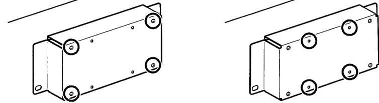
TV背面のネジをはずし、カードを挿入(\*)してから壁掛けユニット取付け用アダプターを取り付けてください。
